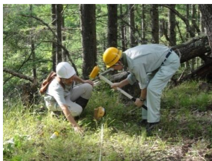
図 2.2.2 移動杭の設置
