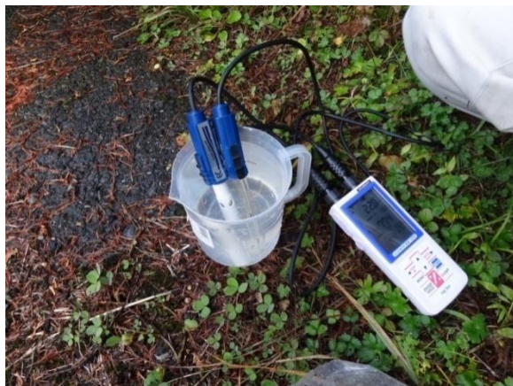
図 2.3.3 電気伝導計度の測定
