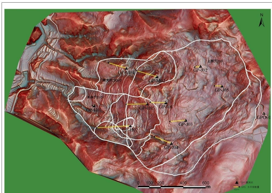
図 3.2.10 GPS 観測点ベクトル図の例（小塩地すべり）
