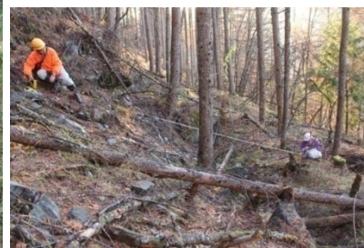
図 2.2.4 メジャーによる移動杭間の距離の測定
